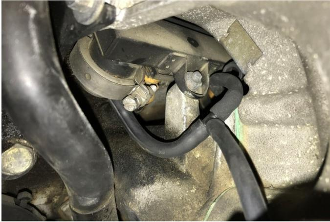
La durite de pression des gaz d'admission doit être posée, à l'aide du raccord en T sur la durite menant au régulateur de pression de carburant.
