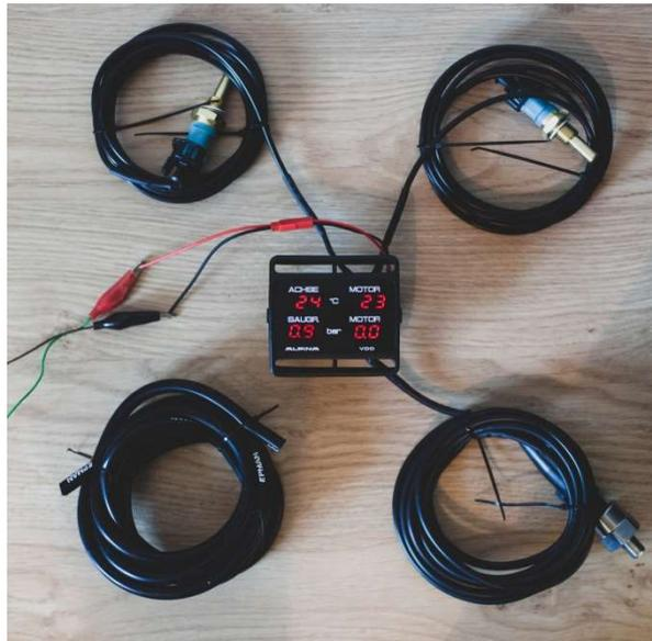
Votre kit est constitué des pièces suivantes : 1 unité de contrôle, 2 sondes de température, 1 sonde de pression, 3 faisceaux, 1 durite de gaz d'admission, 1 raccord en T pour la durite, 1 adaptateur métrique pour installer la sonde de température sur le pont, fournitures diverses ...
